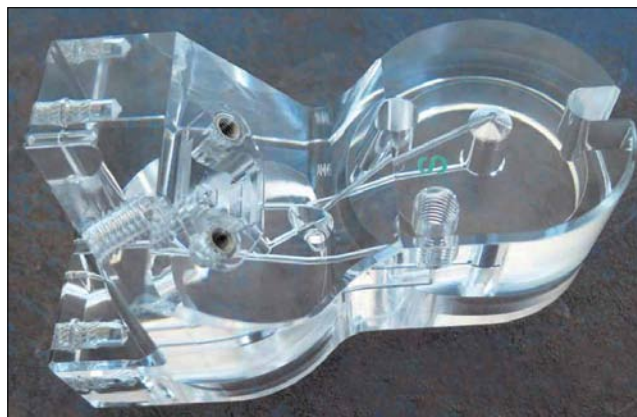
Прозрачная акриловая компонента медицинского устройства, изготовленная на одном из 5-осевых обрабатывающих центров компании Connecticut Plastics по УП, подготовленной в Mastercam Mill 3D и Multiaxis
