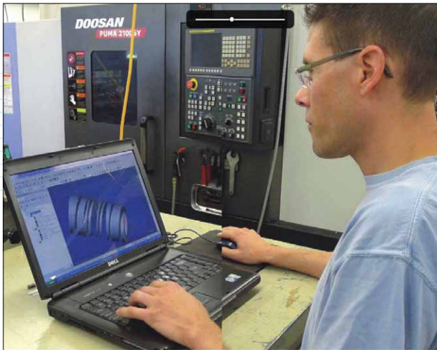
Процесс изготовления пружинной компоненты на станке Doosan с активным инструментом разрабатывался в среде Mastercam Lathe
