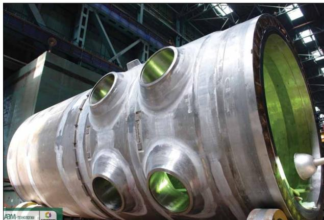
*Корпус ядерного реактора ВВЭР-1000*
