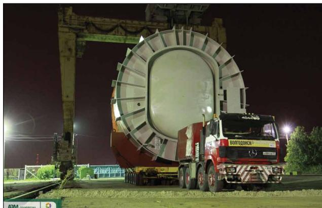
*Корпус шлюза транспортного на специализированном причале*
