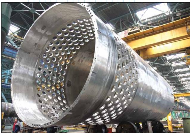
Шахта внутрикорпусная корпуса реактора ВВЭР-1200
