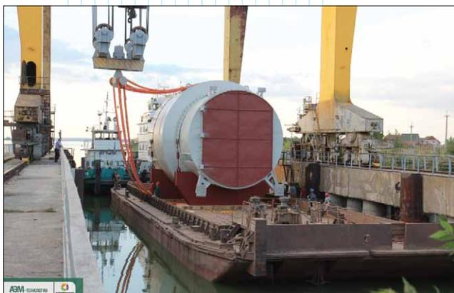
*Отгрузка шлюза транспортного на Нововоронежскую АЭС-2*
