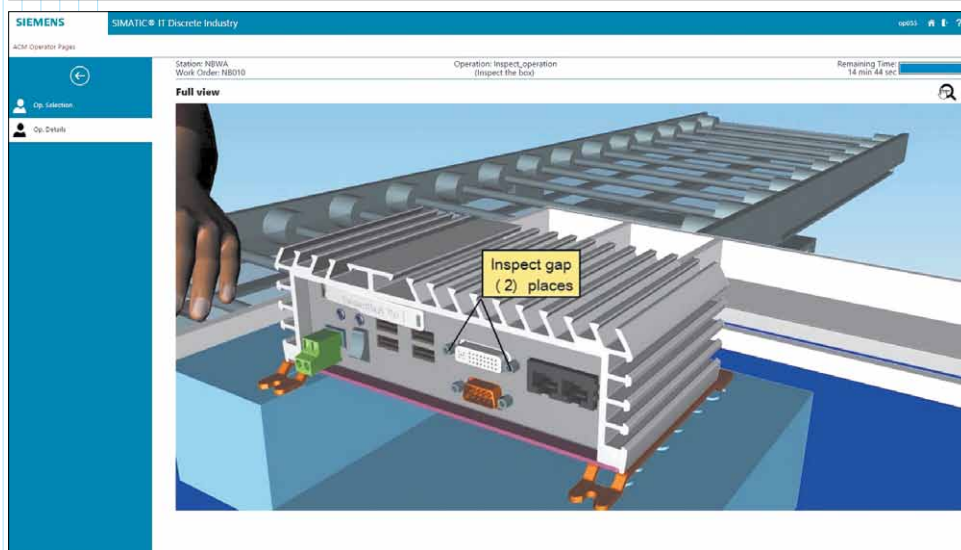
Рис. 8. Цифровой двойник непосредственно связан с автоматизированной системой управления производством, что гарантирует надлежащее исполнение операций в цехе. На иллюстрации представлена электронная рабочая инструкция, связанная с техпроцессом, которая выводится для операторов оборудования на цеховом терминале SIMATIC IT
