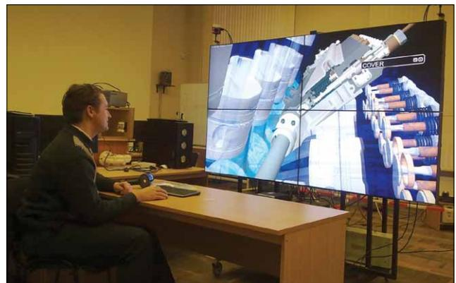
Рис. 7. Иллюстрация интерактивного анализа модели дизеля с использованием видеостены 4 LCD NEC 46" UN и оптической системы трекинга TrackPack2
