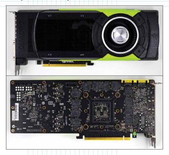
Напомним: оригинальная версия Quadro M6000 имела 12 Gb видеопамяти, для чего на плате распаивалось 24 микросхемы GDDR5 емкостью по 4 Gbit. Теперь же на рынке стали доступны чипы видеопамяти объемом 8 Gbit; благодаря им, обновленная модификация M6000 получила в свое распоряжение 24 Gb, что на данный момент — максимально возможный объем, достижимый с имеющейся в GM200 шиной памяти шириной 384 бит.
