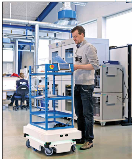
Рис. 4. Автономный робот-помощник MiR100 может перемещаться в помещениях любой планировки со скоростью до 5.4 км/ч, доставляя груз весом до 100 кг. Имеются встроенные датчики для ориентирования и точка доступа для управления через веб-браузер (иллюстрация любезно предоставлена компанией MiR)
