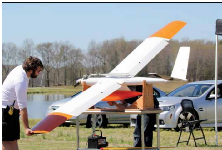
Рис. 1. Дроны компании Skybridge запускаются с колесной тележки или с катапульты (фото предоставлено компанией Skybridge UAS)
