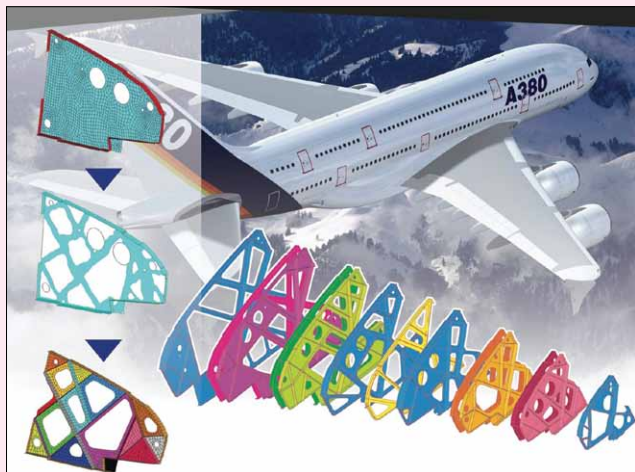
Принципы топологической оптимизации, заложенные в Altair OptiStruct , активно использовались для уменьшения массы самолета Airbus A380
