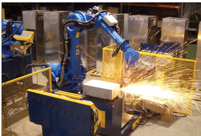
Фотография, взятая из интернета: шлифовка абразивным диском по схеме “Tool-to-Part”
