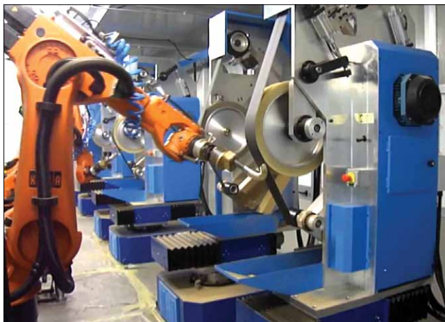
Фотография, взятая из интернета: шлифовка детали методом “Part-to-Tool”, когда робот держит деталь и подводит её к стационарному агрегату шлифовки
