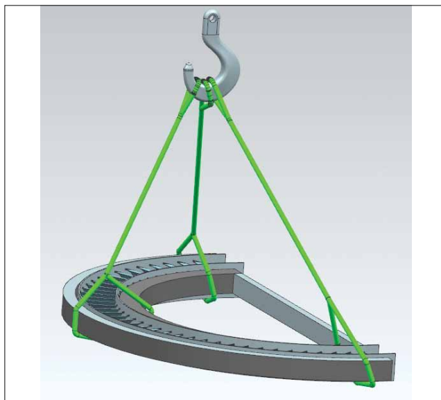
Схема строповки сборки диафрагмы в промежуточном состоянии
