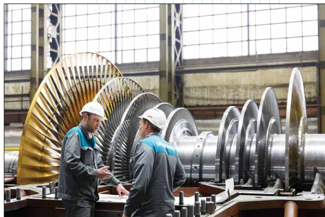
Сборка паровой турбины для АЭС
