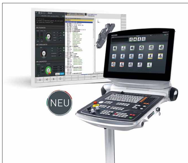
Рис. 3. Интерфейс CELOS с пультом ERGoline диагональю 21.5" для СЧПУ HEIDENHAIN TNC 640 :
