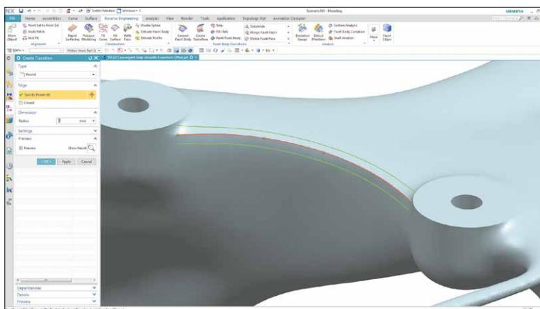
*Добавление гладкого сопряжения к ребру, представленному в виде сетчатой геометрии. Это не колдовство, а гибридное моделирование!*
