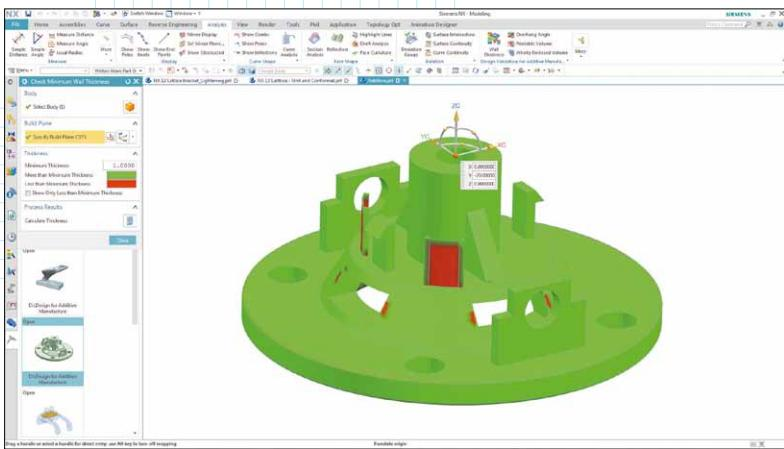
**В NX 12 включены средства выявления часто встречающихся ошибок в конструкциях деталей, предназначенных для изготавления методами аддитивного производства и 3D-печати.**
