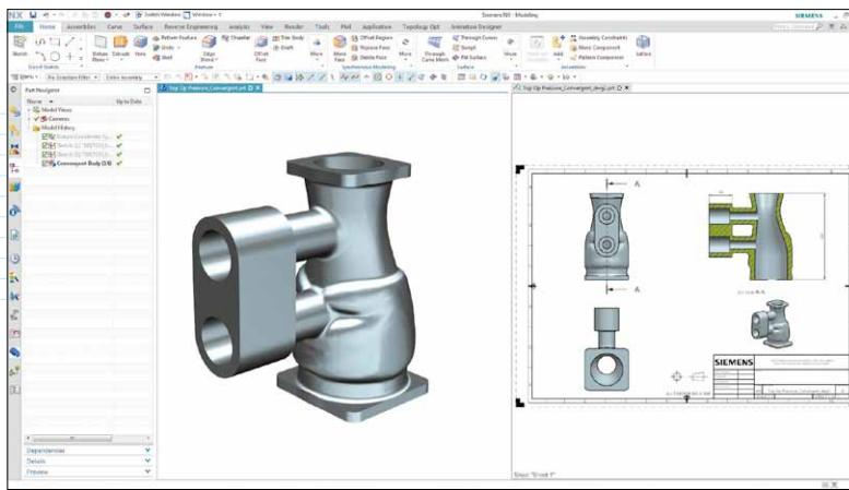
*Новая возможность в NX 12 – добавление элементов оформления к комбинированной геометрии. Хотя речь не идет о полноценной простановке размеров, эта функция, несомненно, окажется полезной для применения рассчитанной на методы аддитивного производства геометрии при разработке документации*
