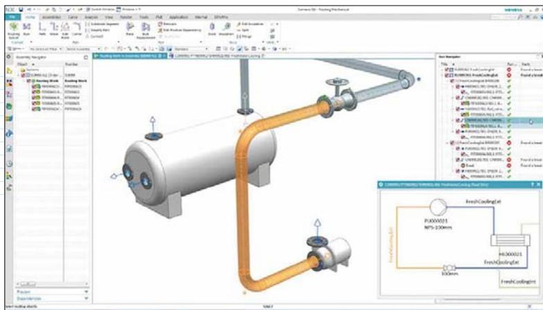
**Новый модуль P&ID Designer объединяет схемы систем с 3D-моделированием деталей и трассировкой трубопроводов**
