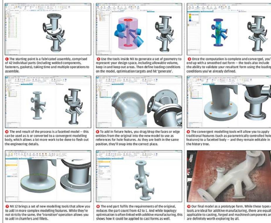
Разумеется, главное преимущество от реализации в *NX* этой технологии состоит в её объединении с гибридным моделированием. Можно взять полученную в результате оптимизации сетчатую геометрию и добавлять к ней все необходимые конструктивные элементы. В новой версии данный процесс стал более простым и эффективным.
