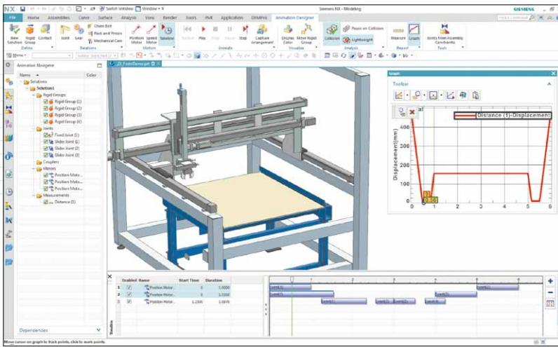
*Модуль Animation Designer выполняет анализ кинематики робота-манипулятора, снимающего детали с конвейера.
