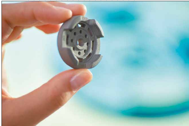
Пример детали, изготовленной по технологии HP Metal Jet на заводе GKN Powder Metallurgy
