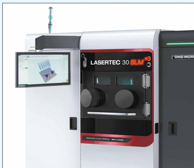
*На рынке оборудования станок LASERTEC 30 SLM впечатляет высоким уровнем надежности и производительности. Благодаря возможности смены модуля подачи порошка, для перехода с одного материала на другой требуется не более двух часов*
