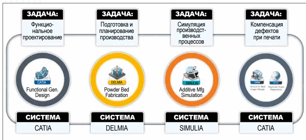
Рис. 12. 3DEXPERIENCE: один из возможных рабочих процессов для АМ (иллюстрация любезно предоставлена компанией Vias Inc. )
