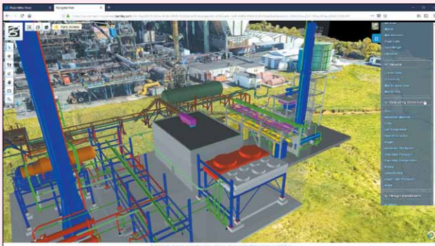
Облачный сервис PlantSight позволяет свести вместе данные из разных 3D-моделей, включая сетки рельефа местности, и получить единое представление, что обеспечивает быстрый доступ к ранее труднодоступной информации
