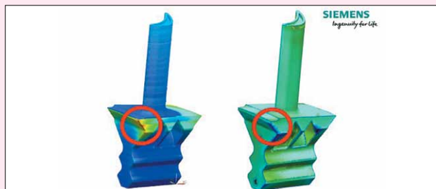
Пример использования решения AM Process Simulation : как показывает иллюстрация, прогнозируемая деформация замка турбинной лопатки (слева) рассчитана абсолютно точно. Для этого геометрия реальной детали сравнивается с её CAD-моделью (справа); в расчетах используется расширенный метод конечных элементов (XFEM)
