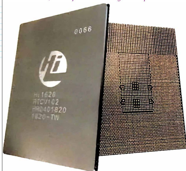
Рис. 5. HiSilicon Hi1620 – 64-ядерный 64-разрядный процессор с архитектурой ARMv8.2-A и тактовой частотой до 3 GHz. Производится по технологической норме 7 nm
