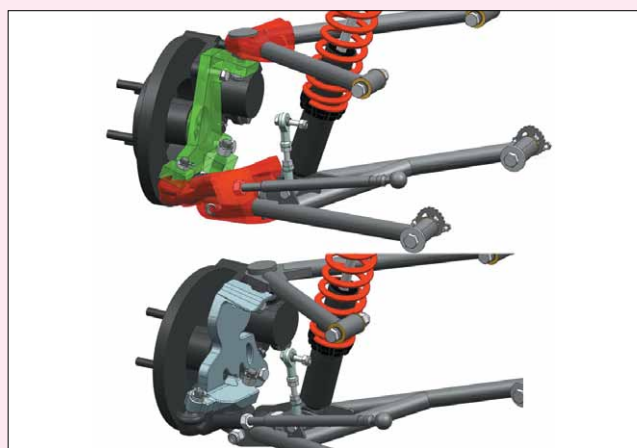
Рис. 5. Оптимизация топологии в Simcenter 3D
