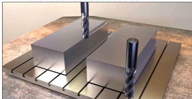
Видеоролик на сайте [mmsonline.com](http://mmsonline.com) наглядно показывает отличие фрезерования с постоянной толщиной стружки в радиальном направлении (справа) от обычного резания (слева)
