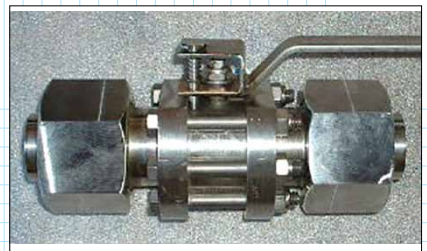
Золотник этого клапана изготовлен из сплава Hastelloy C276. Обычно на то, чтобы обточить заготовку 220 мм до 120 мм, уходит пять часов – частично потому, что для каждой детали придется поменять много пластин. В случае динамичного точения пластинкой радиусом 8 мм время обработки уменьшается до 40 мин, при этом используются одна-две пластины на деталь
