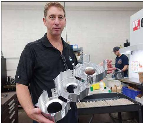
*Эта деталь самолета фрезеруется из алюминиевой призматической заготовки весом 36 кг. После первой операции масса заготовки уменьшается до 4.5 кг. Следующая операция завершает изготовление детали, уменьшая её массу до 1.8 кг. В прошлом на первую операцию обработки, которая удаляет большую часть заготовки, отводилось свыше 8 часов. Сегодня, за счет использования агрессивного фрезерования и технологии *Mastercam Dynamic Motion*, продолжительность цикла удалось сократить до 2 часов 43 минут*
