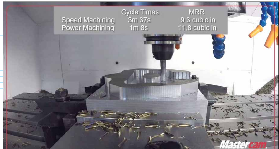
Видеоролик на сайте mmsonline.com показывает отличие “обычной” стратегии RCT от силового резания
