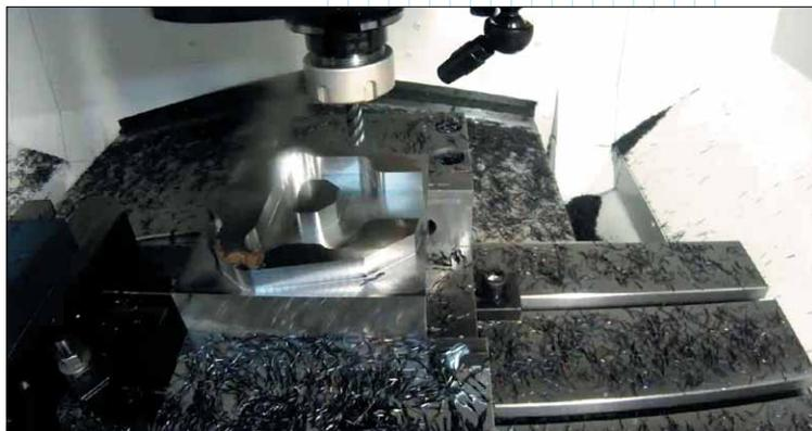
*Материал – сталь 1045. Обработка ведется на вертикальном обрабатывающем центре Okuma M560 на подаче 550 дм/мин со скоростью шпинделя 11300 об/мин. Размер заготовки 5.25” × 5.25” × 2.75” (видеоролик находится на сайте [mmsonline.com](http://mmsonline.com))*
