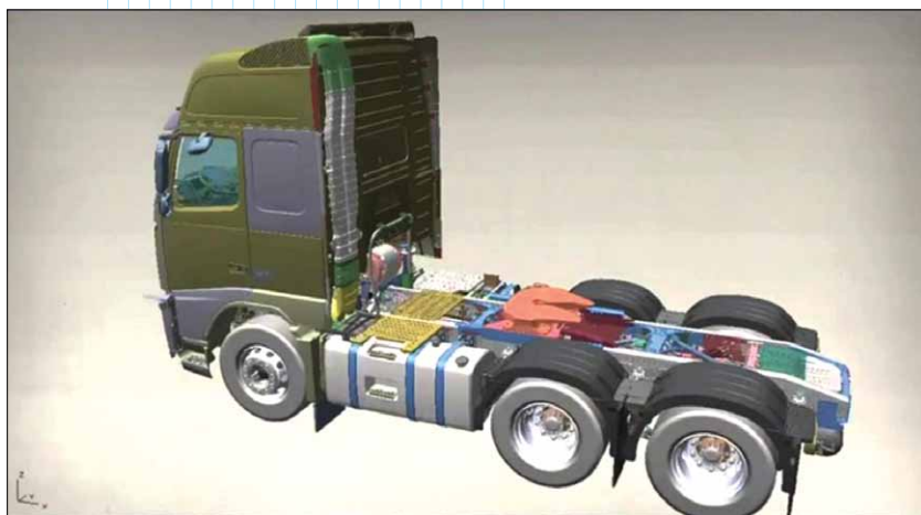
CAD-модель грузовика Volvo. Главным инструментом 3D-моделирования служит CAD-система Creo компании PTC
