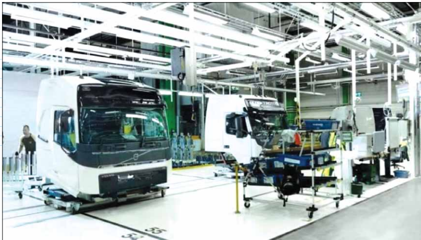
Саморегулируемая производственная система. Компания Volvo стремится создать саморегулируемую производственную систему из высокоавтоматизированных умных рабочих станций, которые могут самостоятельно “плавать” по цеху. Они управляются продвинутым программным обеспечением, направляющим их в те места производственных линий, где их присутствие запланировано или вызывается необходимостью. (Иллюстрация любезно предоставлена Volvo Group)
