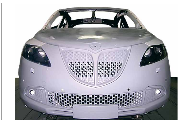
Технологии 3D-печати могут быть объединены с традиционными, чтобы предоставить реалистичный, достоверный прототип, который инженеры по производству и техническому обслуживанию могут использовать для валидации конструкции и процесса производства перед тем, как будут инвестированы средства в подготовку серийного производства
