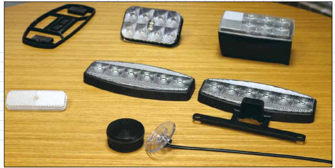
Компания TecNiq сэкономила время и трудозатраты, напечатав прототипы линз промышленного качества. Это позволяет демонстрировать их характеристики еще до создания оснастки для производства
