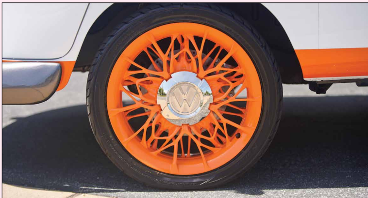
Средства генеративного проектирования позволили уменьшить вес колес на 18%
