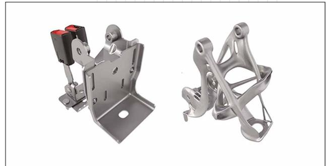
2023 году планируется подготовить 20 новых моделей. С помощью средств генеративного проектирования от *Autodesk* им удалось сделать 3D-печатный кронштейн ремня безопасности из нержавеющей стали на 40% прочнее и на 20% легче исходного варианта, состоящего из восьми сваренных деталей.
