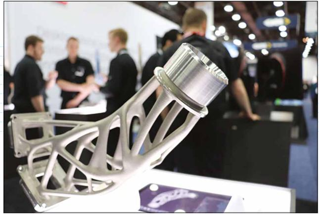
Титановый кронштейн спутника массой 1.7 кг был спроектирован за полдня с помощью средств генеративного проектирования nTop и изготовлен на EBM-станке Arcam Q20 Plus
