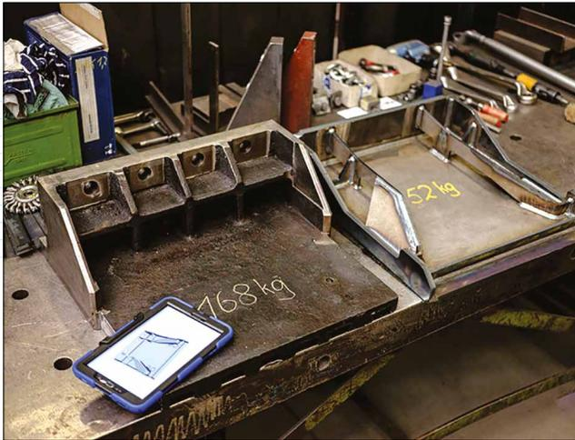
*С помощью этих тяжелых металлических лотков горячий клинкер цемента транспортируют через массивную камеру охлаждения. Функционал генеративного проектирования решения Fusion 360 позволил создать более дешевый и легкий вариант конструкции*
