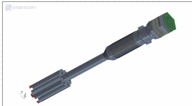
Рис. 3. Расчетная область с граничными условиями (границы симметрии не показаны): • поверхность \Gamma_1 – граничное условие на входе; • поверхность \Gamma_2 – граничное условие на выходе; • поверхность \Gamma_3 – стенки расчетной области
