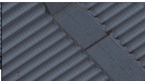
Рис. 8. Расчетная сетка в области дистанционирующей решетки
