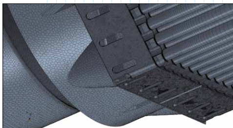
Рис. 7. Расчетная сетка в области уголка хвостовика и нижней опорной решетки
