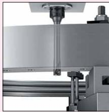
канавок. Профильная обработка узких канавок при большом вылете стала удобнее, появилась возможность выполнения точения вразгонку и формирования полного радиусного дна канавки.
