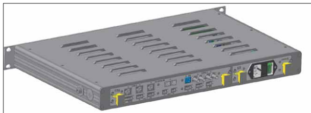
Модель корпуса изделия, построенная с помощью команд листового моделирования КОМПАС-3D
