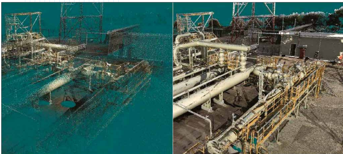
Отображение облака точек по технологии SolidPoint Cloud в сравнении с обычным рендерингом в предыдущих версиях
