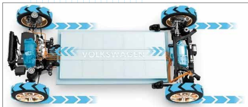
Схематическое изображение передачи мощности на платформе MEB : с главным приводом сзади (на схеме – справа) и опциональным полным приводом (на схеме – слева, в передней части автомобиля)
