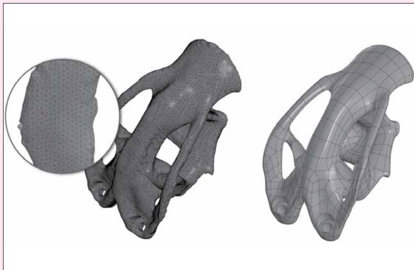
Топологическая оптимизация кронштейна самолета “Борей”, спроектированного в КОМПАС-3D
