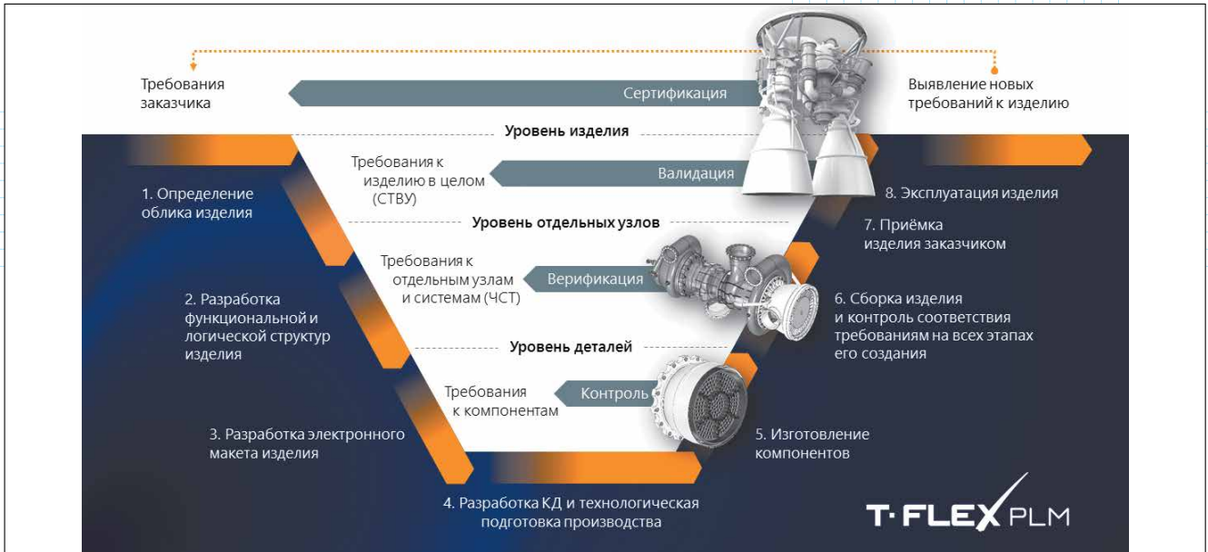
Рис. 10. Разработка изделия на основе требований в T-FLEX PLM
