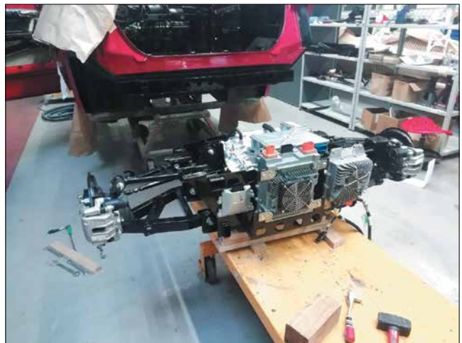
Задняя многорычажная подвеска в сборе с мотором и установленными элементами высоковольтного оборудования
