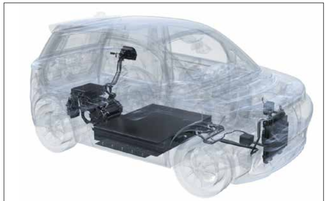
Размещение силовой установки
