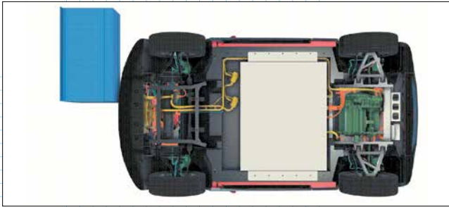
Так моделируют лобовой удар о сминаемый барьер с 40-процентным перекрытием
