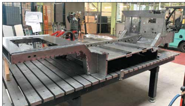
Процесс сборки и сварки каркаса основания на ступе
