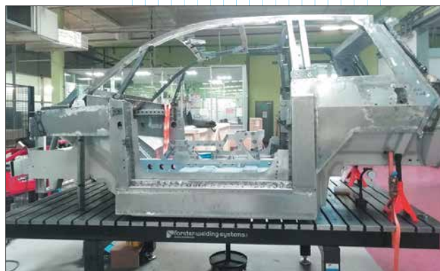
Каркас кузова на натурных испытаниях жесткости
