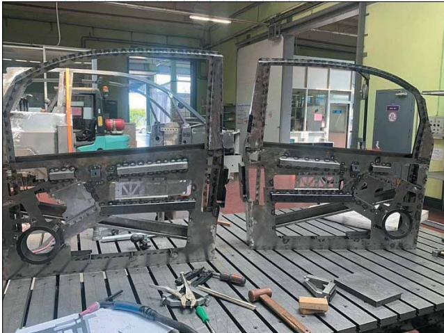
Дверь: так выглядит любая сваренная железяка до того, как зачистили сварные швы
