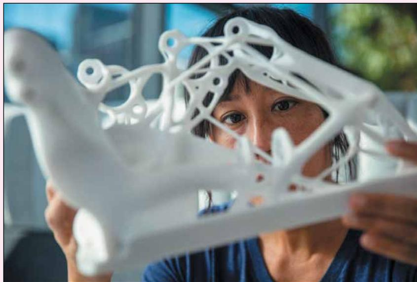
Напечатанный на 3D-принтере прототип детали, модель которой была создана в среде Autodesk Fusion 360 с помощью расширения для генеративного проектирования
