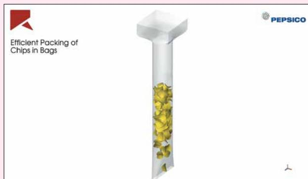
В отличие от традиционного *DEM*-кода, *Ansys Rocky* может точно интерпретировать форму частиц, в том числе произвольные трехмерные формы, двумерные оболочки, а также гибкие волокна, что помогает инженерам быстро решать сложные задачи проектирования.
