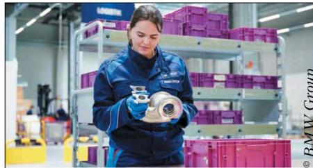
Комплекс аддитивного производства компании BMW: проверка качества деталей, изготовленных по технологии 3D-печати металлическими порошками
