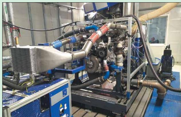
*Опытный образец и стендовые испытания опытного образца литого коллектора на ПАО “КАМАЗ”*
