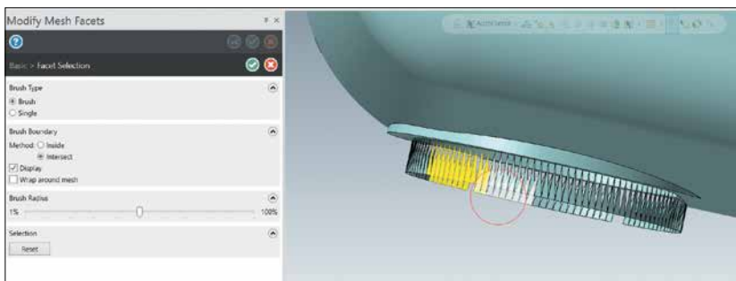
Рис. 17. Процесс выделения элементов сетки, которые необходимо удалить
