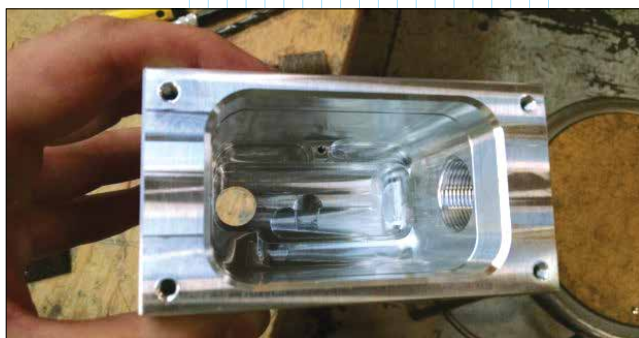
Помимо уменьшения числа установов детали и оптимизации процесса обработки, 5-осевое фрезерование позволяет компании McAfee Tool & Die изготавливать такие детали, от которых раньше приходилось отказываться из-за сложности. Одним из примеров может служить эта особая электрическая распределительная коробка, используемая на нефтяных вышках
