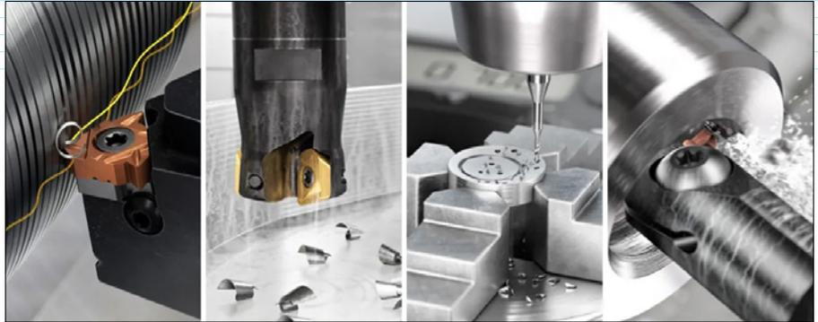
инструменты с профильной впайкой вставок из поликристаллического алмаза обладают повышенной стойкостью даже в сложных областях применения.
