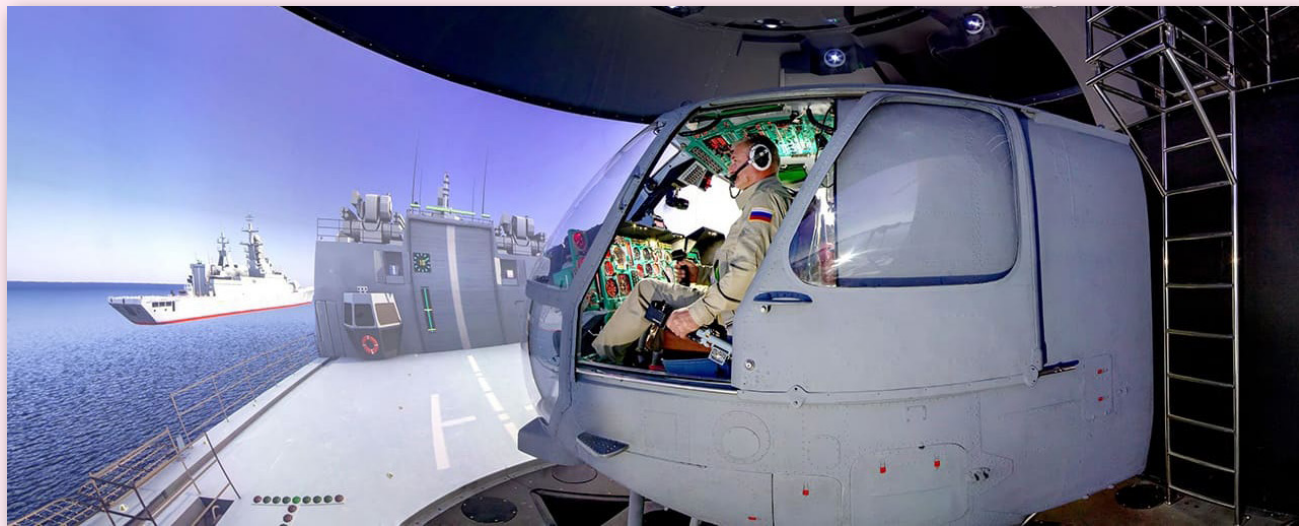
Тренажер для подготовки личного состава, эксплуатирующего вертолет КА-27М. (Источник: АО ЦНТУ “Динамика”)
