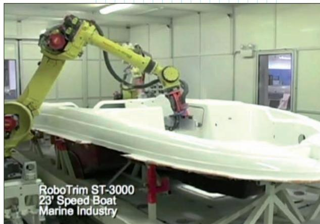
Робот фрезой вырезает окна в стекловолоконном корпусе моторного катера (KMT Robotic Solutions)
