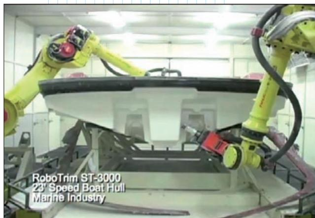
Одновременная обрезка частей корпуса и обработка вставки повышения плавучести для быстрого катера (*KMT Robotic Solutions*)
