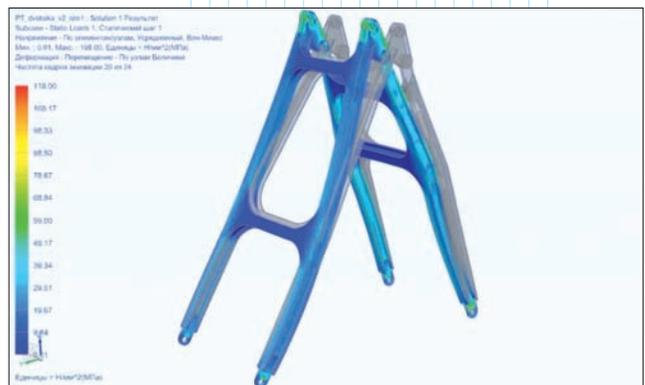
*Расчет двуногой стойки, условно показано, как она отклонится под нагрузкой*
