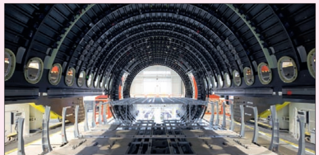
Композиционная секция фюзеляжа, изготовленная компанией Spirit AeroSystems (Северная Каролина, США), готова к отправке на Airbus
