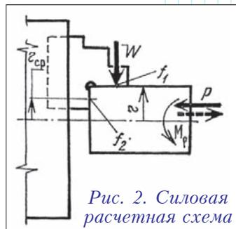
Рис. 2. Силовая расчетная схема
