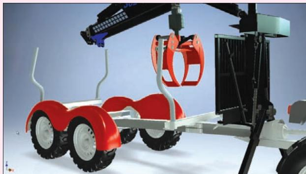
*Рис. 1. Создание свободных форм (Freeform). Интегрированная в Inventor 2015 технология T-Spline предлагает вести проектирование деталей произвольной формы на любой стадии проектирования. При этом достаточно сложные поверхностные формы можно строить и редактировать непосредственно на модели и в реальном режиме времени*
