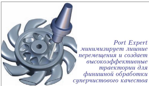
Приложение *Mastercam Port Expert* предлагает несколько специальных опций. Можно запрограммировать обработку только верхней или только нижней части канала; можно определить припуск, оставляемый под дальнейшую обработку для всего канала.
