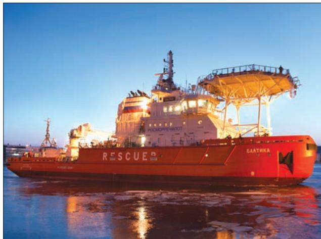
необходимых для работы ледоколов, а также экономить топливо за счет компактного размера судна. Имея ширину всего 20.5 метров, судно способно прорубить канал шириной до 50 метров; при этом осадка судна составляет всего 6.3 метра, что делает его совершенно универсальным. “Балтика” требует всего 7 МВт тяговой мощности, в то время как обычный ледокол требует 17÷20 МВт.
