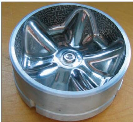
*Рис. 8. Деталь после фрезерной 3-осевой обработки и гравировки*
