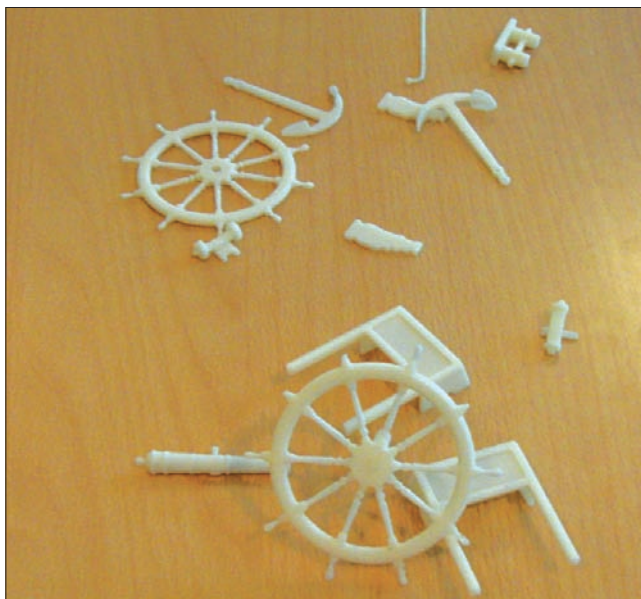
К итоговому занятию изделие “Штурвал”, спроектированное слушателями курса средствами Creo 2.0 , было напечатано на 3D-принтере
