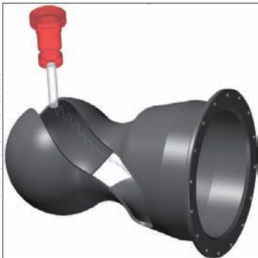
*Новая 3D-траектория с осциллирующей инструмента, предлагаемая в системе Mastercam X7, позволяет распределить износ по определенному участку рабочей зоны инструмента, что предотвращает образование на нём канавки*
